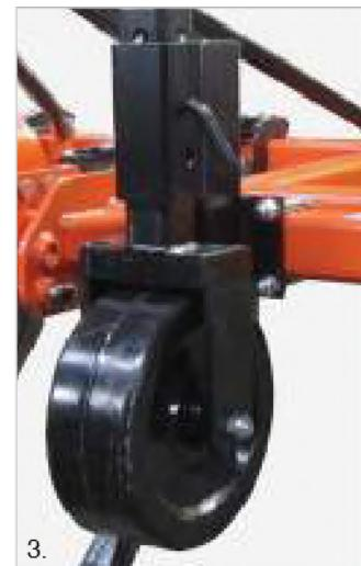
1. Șurubul de forfecare asigură protecția cadrului / Предпазният винт предпазва рамката и анкера 2. Dublu tăvăluc cu colți, reglabil hidraulic / Ролките с двойно зъбно колело се регулират хидравлично 3. Roată de copiere din oțel, reglabilă manual / Стоманени колела се регулират ръчно
